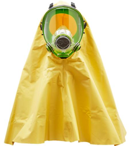
Лінза маски BLS 5700/C має оптичний клас 1 (EN 166), забезпечує панорамне поле зору без оптичних спотворень. Склоподібна обробка поверхні лінзи робить її стійкою до подряпин. Система вентиляції розроблена так, щоб уникнути запотівання лінзи шляхом контролю потоків холодного та гарячого повітря всередині маски замість використання обробки поверхні, яку можна легко зіпсувати.
